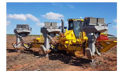
ブラッケ社製アタッチメントをブルドーザーに 取り付けた植林機
