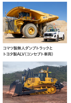
鉱山向け大型ICTブルドーザーD375Ai-8 遠隔操作仕様車
