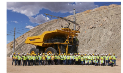
トローリー給電式バッテリーダンプトラックと 「コマツGHGアライアンス」のメンバー
