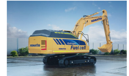
水素燃料電池を搭載した 中型油圧ショベル(コンセプトマシン)
