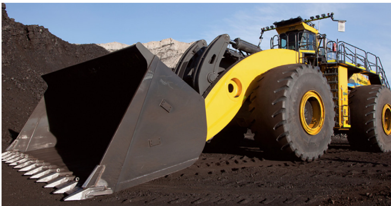
P&Hブランドのホイールローダー「L-2350」。従来コマツ最大のホイールローダー「WA1200」の約2倍となる40.52 m 3 の標準バケット容量を誇ります。
