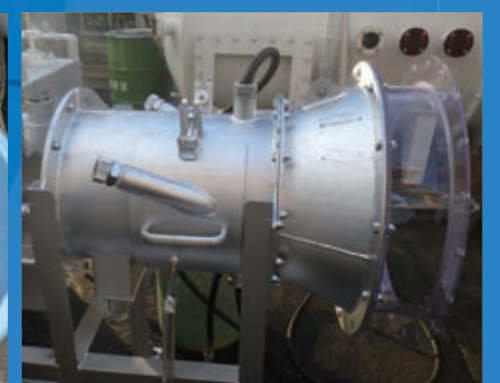
プラント装着前の共同開発した炭化燃料燃焼バーナ
