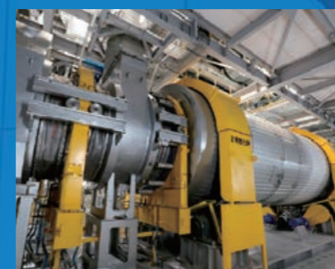
長崎県西海市のごみ炭化燃料製造施設で稼働中の川崎重工製炭化炉(資料提供：川崎重工業株式会社)
