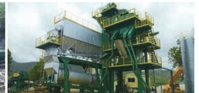
NBD120MBD-AR タイ向け 加熱リサイクル増設用 アスファルトプラント 2016年納入
