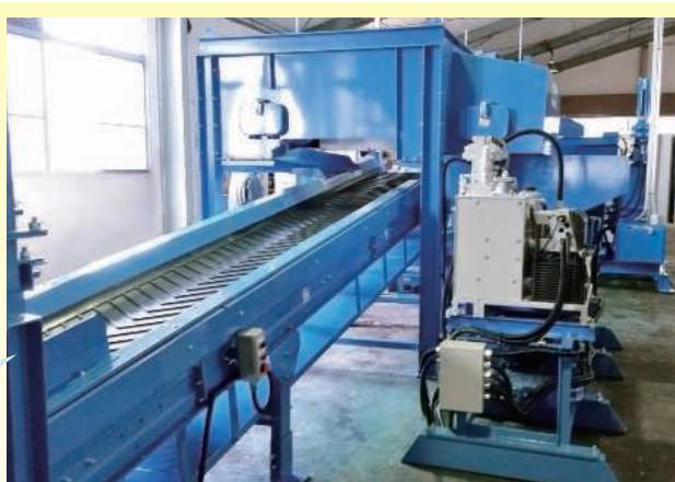
手選別コンベヤと吊り下げ式磁選機
