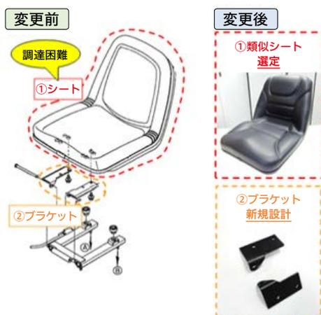
部品そのものの再設計だけでなく、類似部品を選定し、組付けの互換性を確保するため追加部品を新規設計し、代替可能にする取り組みも行っています。
