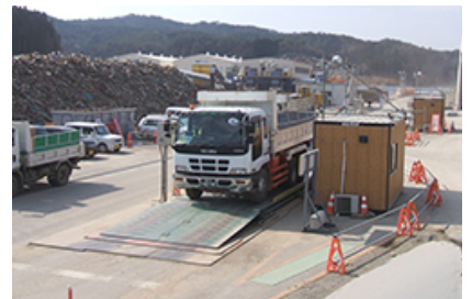
トラックスケール(トラックに積載された瓦礫などの重量を計測)
