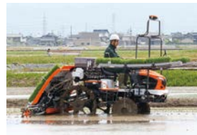
田植機 稲の苗を水田に移植します。省人・軽労化に大きく貢献します。
