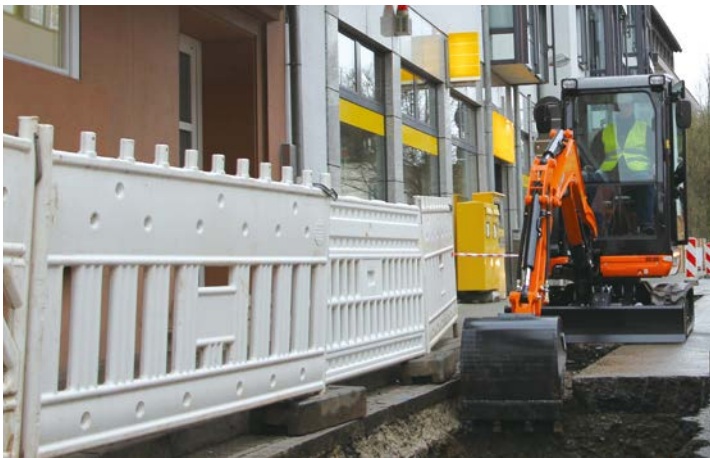
ミニバックホー 土木作業などを行います。市街地など狭い現場を得意とします。
