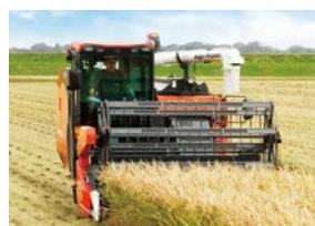
自動運転アシスト機能が付いたアグリロボコンバイン
