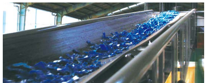
破碎・リサイクルプラント 資源ごみを破碎・選別し、資源価値を高めたり、再利用・原材料化や燃料化する施設です。
