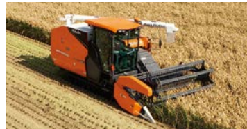
コンバイン 米や麦、豆類などを刈り取ると同時に脱穀します。
