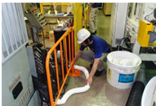
油漏洩を想定した流出防止訓練 日本プラスチック工業(株)本社工場
