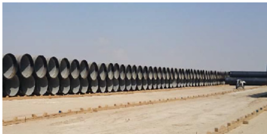
送水管として利用されるダクタイル鉄管
