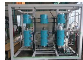
当社の実証範囲であるガス改質プロセスに係る「ガス改質実証試験設備」
