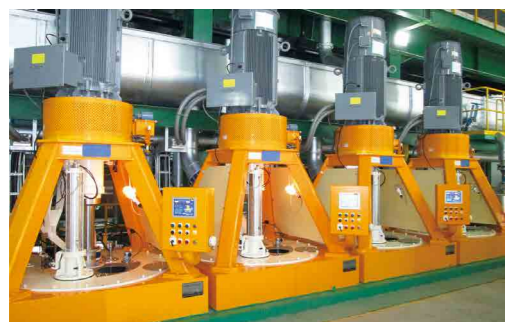
製糖用分離機 (砂糖の結晶を分離) 全世界へ1,000基以上納入
