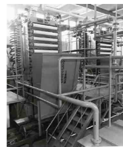
堅型フィルタプレス 汚泥の含水率を大幅低減し 全国の上下水道施設で活躍
