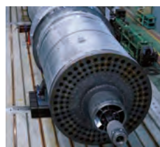
産業用大型乾燥機 スチームチューブドライヤ
