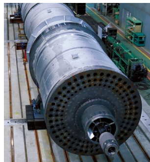
産業用大型乾燥機 スチームチューブドライヤ
