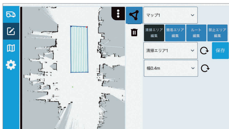
▲ 新開発のアルゴリズムにより、指定エリアの最適清掃ルートを自動作成
