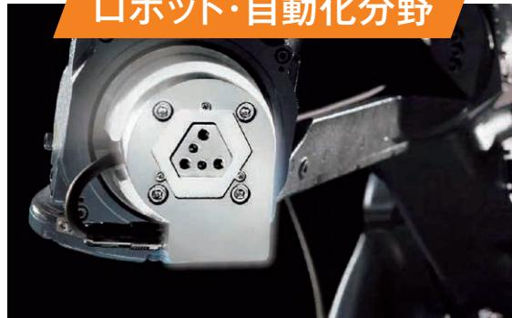
力覚センサにより作業者の力加減を再現し、自動化の世界を進化させる
