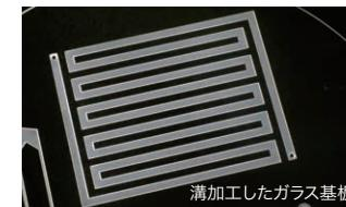
溝加工したガラス基板
