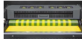
インカーカバーを密閉化し、インカー内に発生するインキミストを専用フィルターに吸引回収します。
