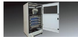
各印刷ユニットより回収したVOCを光触媒を利用したフィルターにより無害化します。
