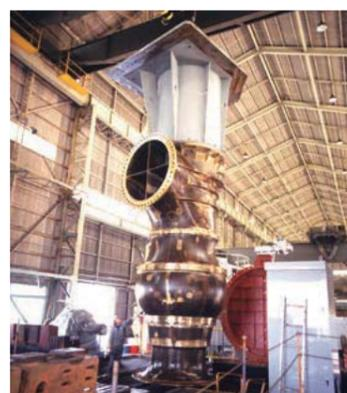
サウジアラビアのコンビナート向け世界最大級(当時)の立軸斜流循環水ポンプ。(1980年)
