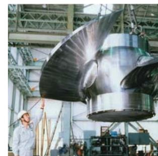
毎秒30m<sup>3</sup>の雨水排水を行う、口径3,600mmの立軸可動翼軸流ポンプのプロペラ。(1993年)
