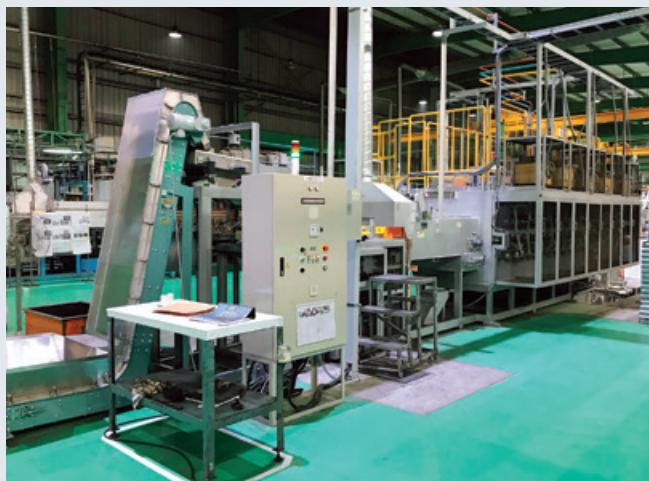
▲新規導入した熱処理炉
