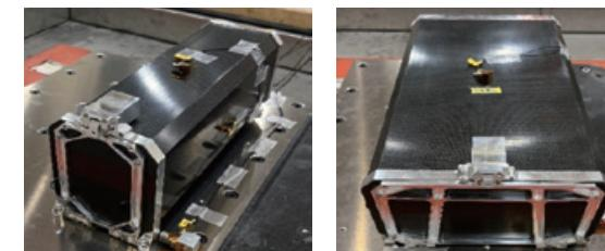
CFRP製衛星放出機構
