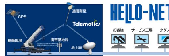
通信衛星や携帯端末などを用いてクレーンの稼働状況をリアルタイムで手軽に把握。故障の前兆をキャッチし、事前にメンテナンスする「ビフォーサービス」を可能にします。ラフテレーンクレーンを中心に標準搭載化を進めており、日本で約7,500台、海外では約4,500台が稼働。現在はオールテレーンクレーンや高所作業車へも展開しています。
