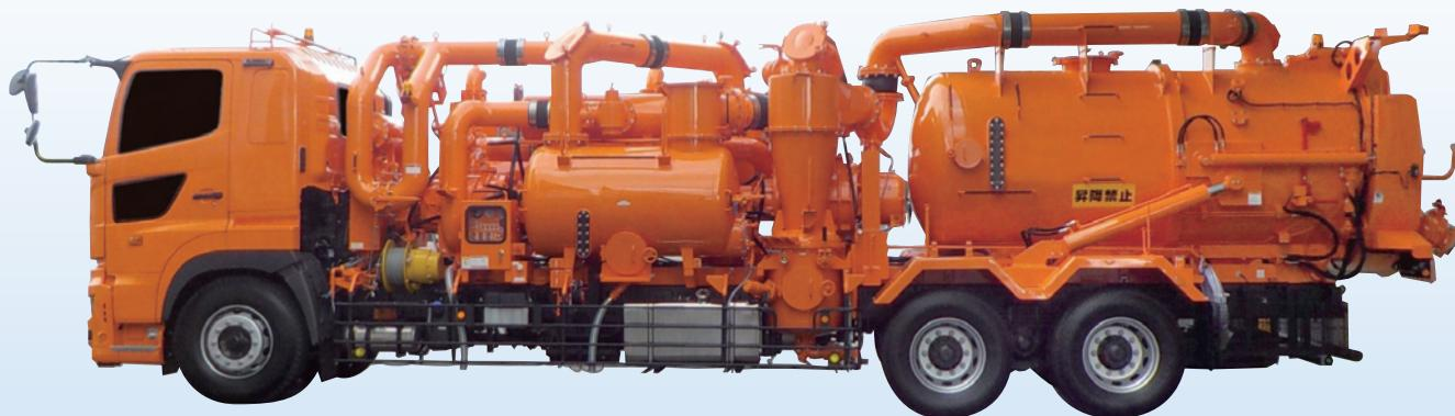
本製品は、車輛のエンジンによる駆動（PTO駆動）の物ではクラス最大吸引風量140m<sup>3</sup>/minの超強力吸引作業車です。
