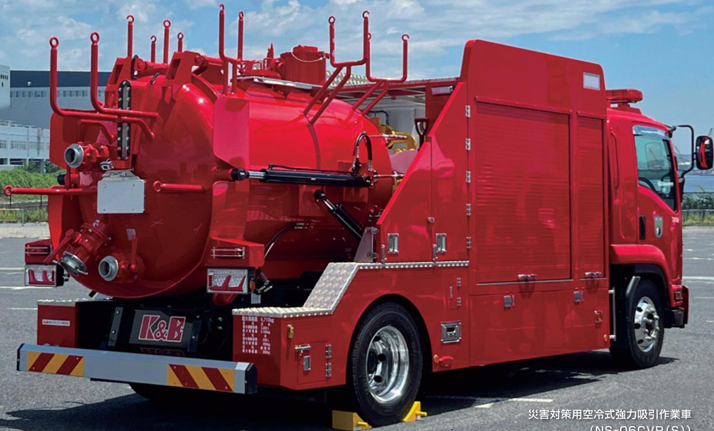
災害対策用空冷式強力吸引作業車
