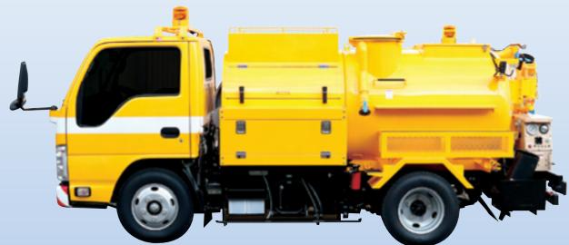
本製品は、狭い場所での作業に適した、小型車架装の車輛です。都市部などで強力吸引作業車と高圧洗浄車を合わせて2台で運用することを想定し、コンパクトにしました。
