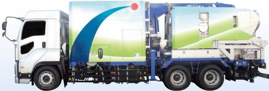
本製品は吸引した粉粒体を助手席側の「サイクロンホッパー」で袋詰めし、回収しきれなかった粉粒体を、運転席側のフィルターを備えた「バグホッパー」により袋詰めする二段構えの専用車です。周囲に粉粒体を飛散させることなく、ほぼ100%の回収が可能です。機能・環境の両面に優れた性能を誇っています。また、クレーンを装備しており、荷役作業にも対応できます。
