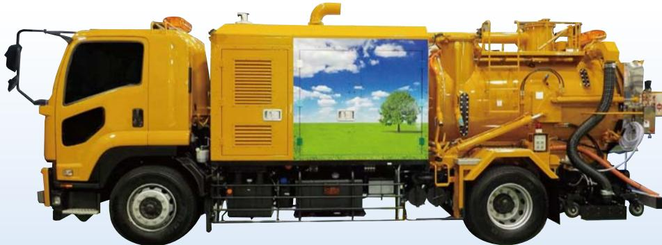
本製品は粉塵が飛散しない、新しい方式の路面清掃車です。路面に高圧水を噴射し、粉塵を浮かして吸引回収します。回収した洗浄汚水を洗浄水として再利用し、リサイクル等環境に配慮した開発を行ってきました。
