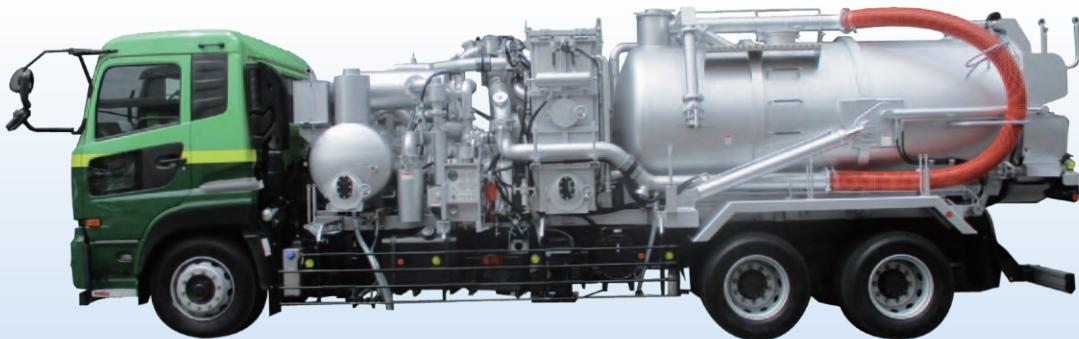
本車両は、バグフィルターユニットを搭載し、バルブの切換え操作により、粉粒体・汚泥のどちらでも吸引が可能な超強力吸引作業車です。
