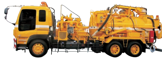
水循環式配水管清掃車(CS-13BJPR)
