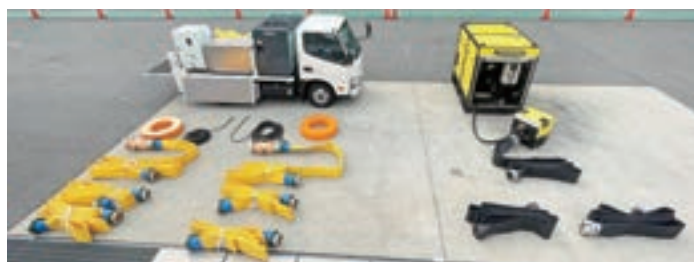
浸水・冠水現場での排水時に活躍する排水ポンプ
