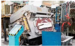
WBM2号保持炉では、溶湯温度保持の為毎日24時間「入り切り制御」で電力を消費している
