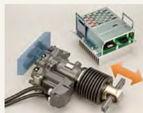
鉄道車両の横揺れを制御する動揺防止アクチュエータ
