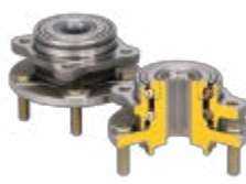
内・外輪フランジ付き複列アンギュラ玉軸受(駆動輪用) [HUBⅢ]
