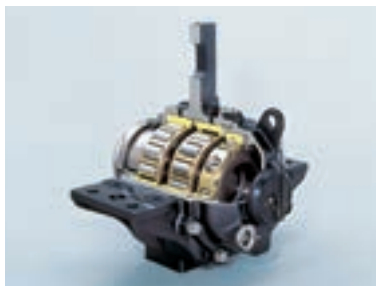
トライボロジー遺産認定の0系新幹線用車軸転がり軸受
