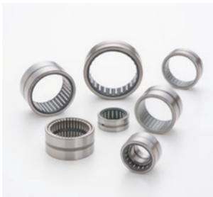
転動体にニードル(針)状の細いローラを組み込んだ回転運動用のベアリングです。ボールベアリングと比較して、断面高さが低く、負荷容量が大きいのが特長です。機械全体をコンパクト化し、省スペース化に貢献します。
