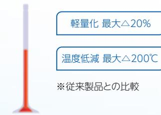
傘中空エンジンバルブの断面図
