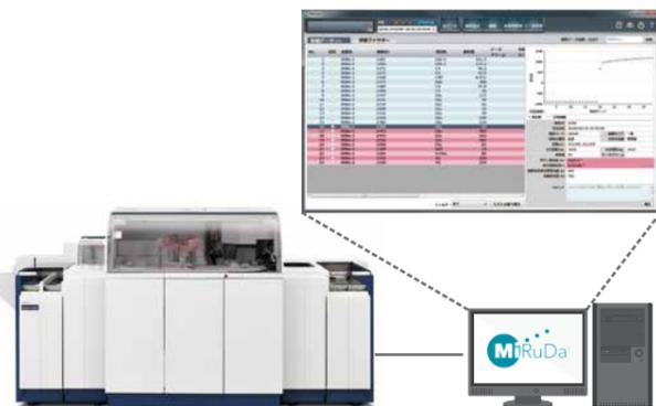
自動分析装置 LABOSPECT 008 α と 反応過程近似解析ツール MiRuDa
