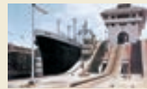
パナマ運河 曳船用電気機関車
