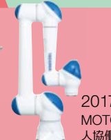
2017年 世界初 GaNパワー半導体搭載 アンプ内蔵サーボモータ
