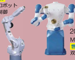
1995年 MOTOMAN-SK16 自社ACサーボモータシリーズ採用 徹底した軽量化・スリム化
