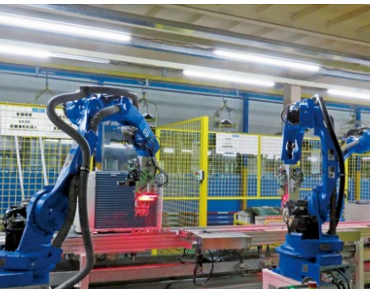
エアコン室外機の組み立て
