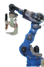
スポット溶接ロボット▲ MOTOMAN-VS100
