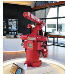
国内初全電気式産業用ロボット MOTOMAN-L10 受注第一号機
