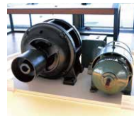
三相誘導電動機 受注第一号機(左) VSモータ 製品第一号機(右)
