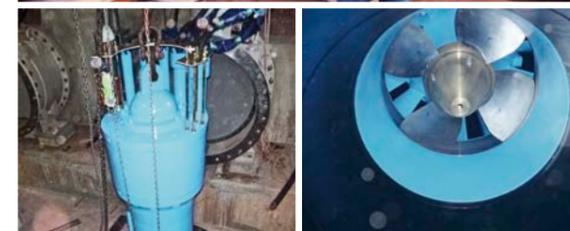
可変速水中タービン発電機
