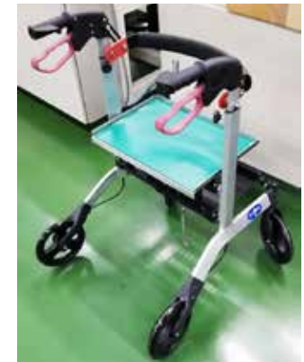
静電対策機能付き専用運搬カート
