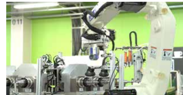
小型 AC サーボモータのロータ組立・検査ライン
