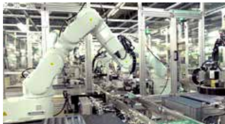
富士山工場 アンプ基板 組立ライン
