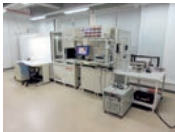
ダブルチャンバー測定装置 （ファンの風量・静圧測定装置）
