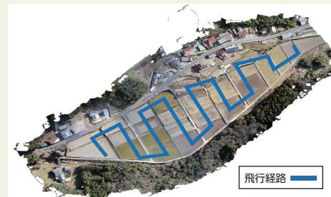
UAV(自律飛行)による農用地等の利用状況調査イメージ図
