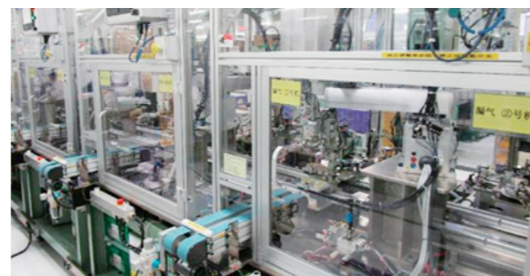
自動化されたモーター性能検査機
