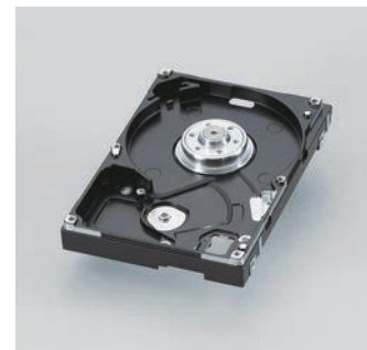
*HDDのベースプレートとモータ。中央部分がHDD用モータで、周りの黒い部分がベースプレート。
