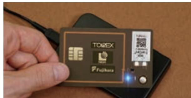
日本ガイシ(株)のEnerCera電池、(株)フジクラのNFCコイル基板とのコラボレーションによる、非接触&瞬時ワイヤレス充電ソリューション
