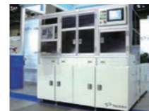
三次元検査装置
