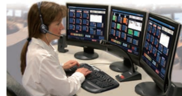
デスクトップ型無線コンソールシステム(Zetron) 事務所、作業場などから、電話機操作と同じように離れた場所にある無線機の遠隔制御やコミュニケーションができる無線制御操作機(卓上端末)です。
