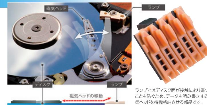
ランプとはディスク面が接触により傷つくことを防ぐため、データを読み書きする磁気ヘッドを待機格納させる部品です。
