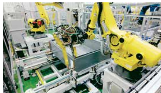
自動ロボット(鋸金・溶接)
