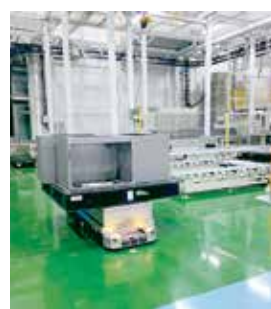
自律走行搬送ロボット(AMR)。人や障害物を避けて、自らが走行ルートを決定する。
