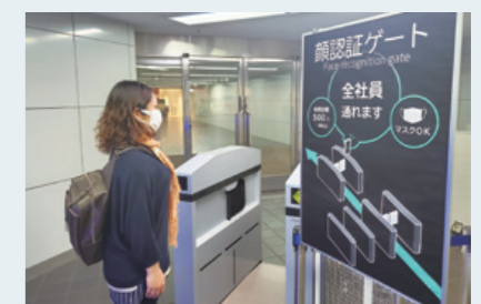
マスク着用時でも顔認証が可能な入場管理システム (NEC本社ビル地下1階の従業員通用口)
